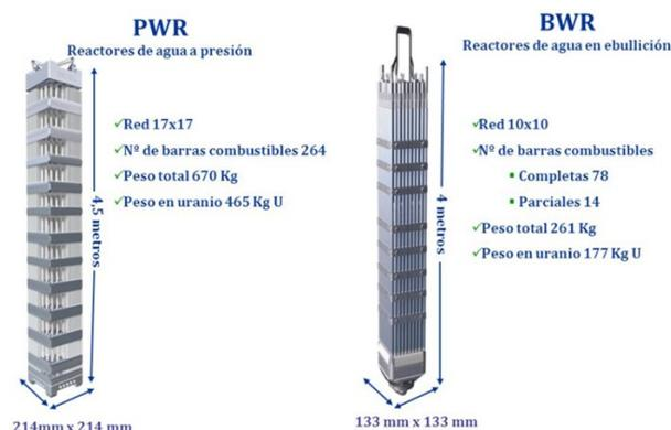
Figura 1. Ejemplo de elemento combustible reactores PWR y BWR. Fuente (ENUSA, 2013)
